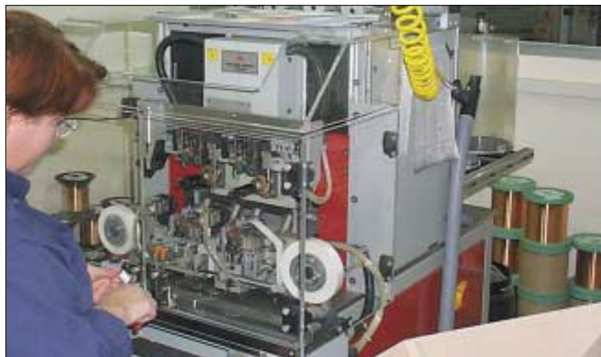
Opération de bobinage de l'inducteur d'un électroaimant.
