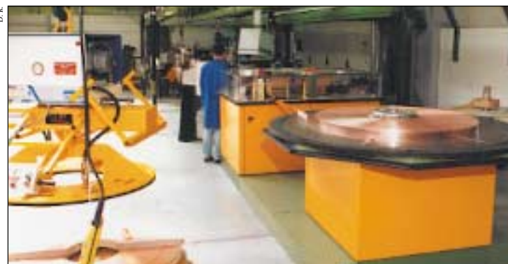
Ligne d'adhésivage des bandes métalliques pour puces électromagnétiques.
